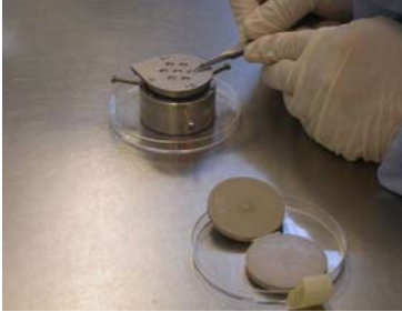
Applying silicone to mini lids:
